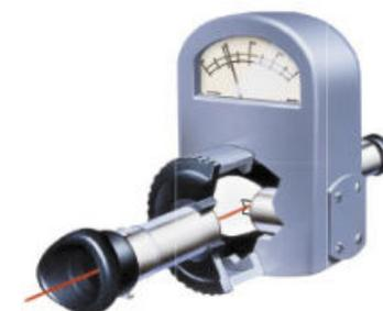
Figura 1.36 El pirómetro es un dispositivo para medir la temperatura de un cuerpo sin tocarlo, gracias a la radiación que éste emite.
