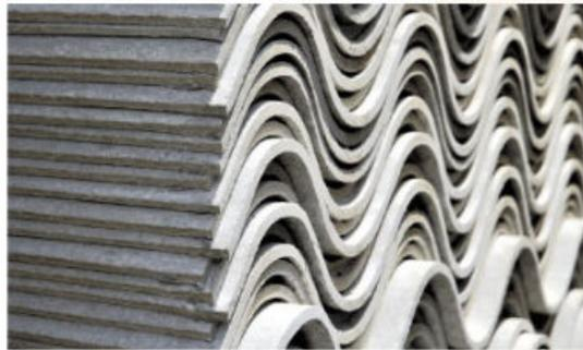
Figura 2.69 Los asbestos son materiales muy utilizados por sus propiedades únicas: resistentes al fuego, aislantes térmicos, no reaccionan con otras sustancias químicas y no conducen la electricidad, además de su precio relativamente bajo.
