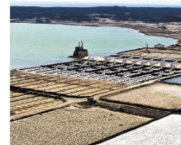
**Figura 1.50** El agua de mar tiene entre 3% y 5% de concentración de sal. Al dejar que se evapore el agua se obtiene la sal común.
