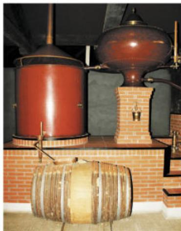
Figura 2.4 El alcohol se separa de mezclas de fermentación aprovechando que su punto de ebullición es menor al del agua.
