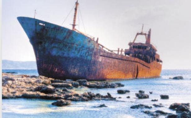
**Figura 4.33** Un fenómeno de corrosión común es la del hierro: este metal se oxida con el oxígeno del aire en presencia de humedad para formar óxido de hierro ( $\text{Fe}_2\text{O}_3$ ). A esta sustancia de color café rojizo se le conoce como *herrumbre*.
